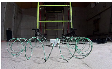
▲ Рис. 9. Тестовый очаг "Перегрев кабеля" без выделения видимого дыма
