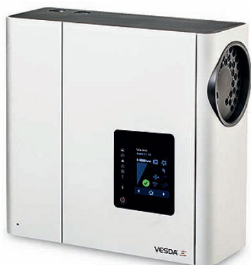
▼ Рис. 6. Лазерный капиллярный аспирационный извещатель нового поколения на 40 капилляров с расширением до 120 капилляров до 100 м
