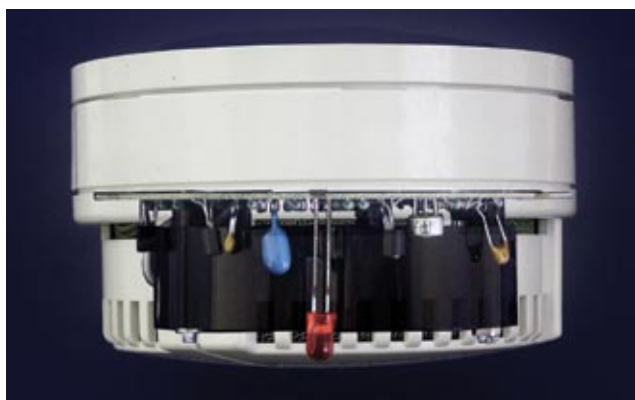
Рис. 5. Конструкция дымового извещателя «ДИП-3»
