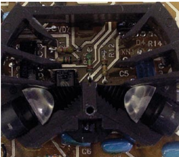
Рис. 8. Конструкция вертикально вентилируемой дымовой камеры
