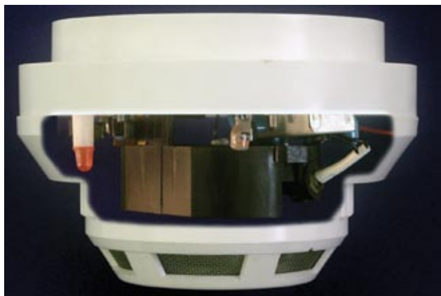
Рис. 4. Конструкция дымового извещателя «ДИП-2»
