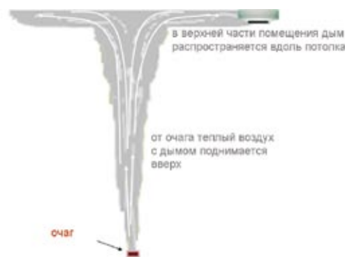
Рис. 1. Распространение дыма от тлеющего очага на первом этапе
