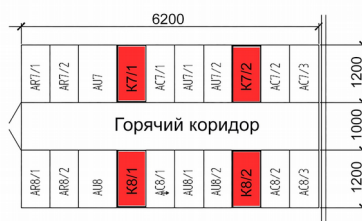
Рис. 9. Межстоечные кондиционеры выделены красным цветом
