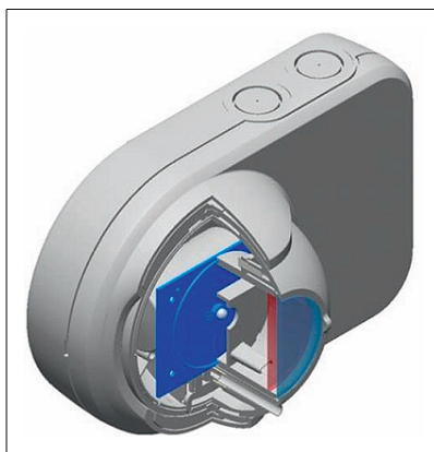
Рис. 8. Конструкция ИПДЛ с УФ- и ИК-излучателем и CMOS-камерой
