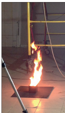
Рис. 11. Тестовый очаг 10х10 см, горение н-гептана ТП-5А
