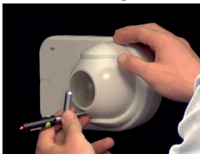
Рис. 10. Юстировка приемника и излучателей при помощи лазера
