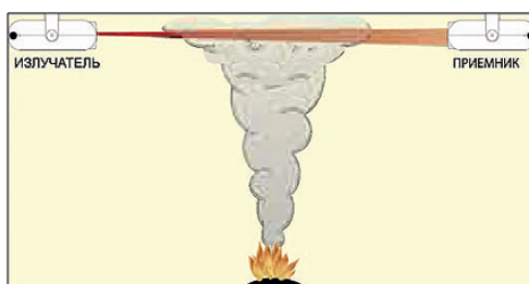
Рис. 1. Размещение излучателя и приемника ИПДЛ 1-го поколения
