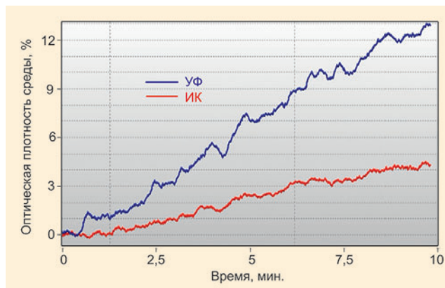
Рис. 4. Испытания по тестовому очагу ТП-3А уменьшенного размера
