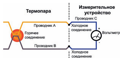
Рис. 7. Принцип работы термопары
