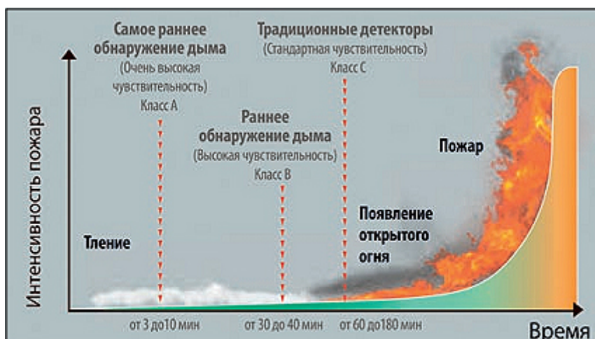
Рис. 1. Время обнаружения очага в зависимости от чувствительности и типа извещателя
