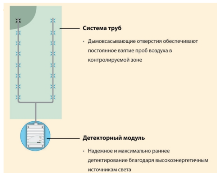
Рис. 1. Принцип работы аспирационного извещателя
