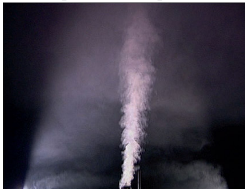
Рис. 2. Задымление в верхней части тестового помещения
