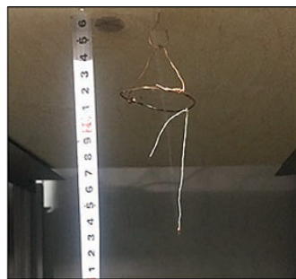
Рис. 7. Тестовый наноочаг для аспирационных извещателей – одна нитка (0,01 г)
