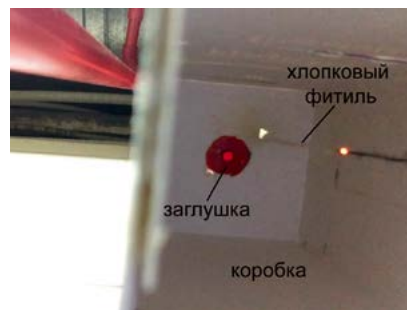
Рис. 4. Тление хлопкового фитиля в коробке (вид сверху)
