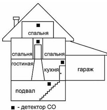
Рис. 1. Пример расположения извещателей СО в жилом здании
