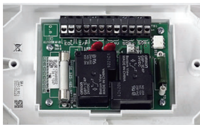
Рис. 8. Релейный модуль саунд бустер SB520
