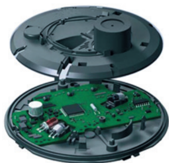
Рис. 7. Расположение светоизлучателей в извещателе FAP DO 420
