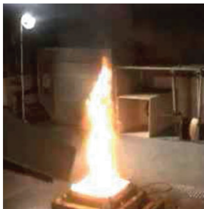
Рис. 4. Размеры очага ТФ4 за 160 секунд, на момент окончания испытания
