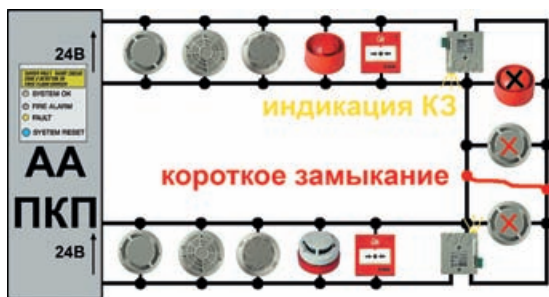
Рис. 6. Короткое замыкание кольцевого шлейфа
