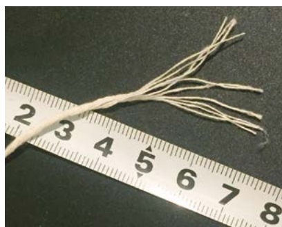
Рис. 1. Хлопковый фитиль свит из 10 ниток
