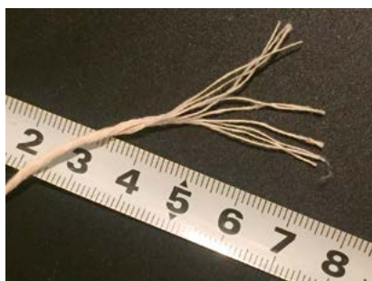
Рис. 2. Хлопковый фитиль свит из 10 ниток
