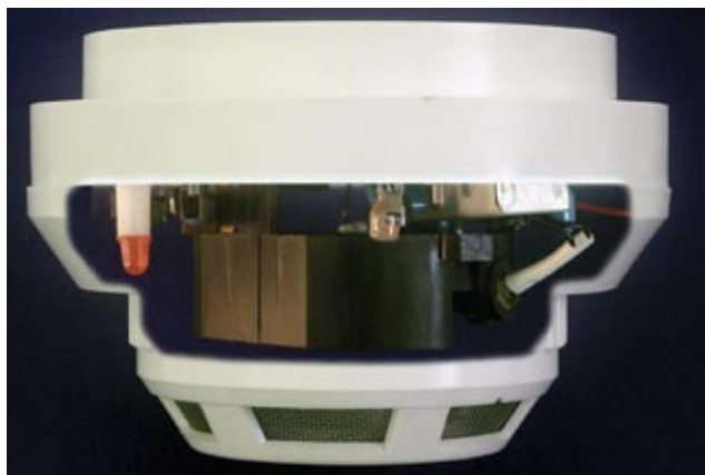
Рис. 4. Конструкция дымового извещателя «ДИП-2»
