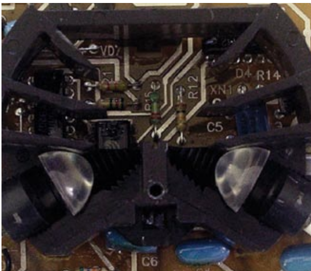
Рис. 8. Конструкция вертикально вентилируемой дымовой камеры
