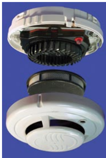
Рис. 13. Конструкция извещателей серий «ПРОФИ» и «ЛЕОНАРДО»
