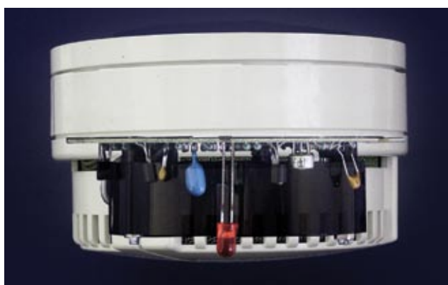
Рис. 5. Конструкция дымового извещателя «ДИП-3»
