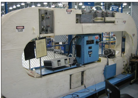
Рис. 2. Стенд "Дымовой канал" для испытаний дымовых извещателей
