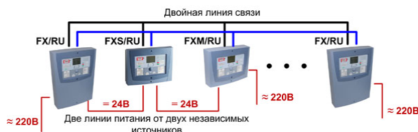
Рис.2. Электроснабжение от двух независимых источников
