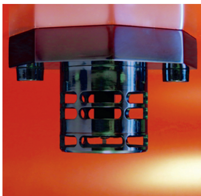
Внешний вид опытных комбинированных ИП дым/тепло нового поколения
