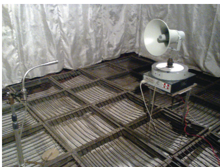
Рис. 2. Испытание громкоговорителей ROXTON в акустической заглушенной камере МТУСИ
