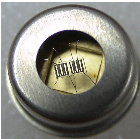
Рис. 2.12. Газочувствительные элементы на основе нанокристаллических тонких пленок
