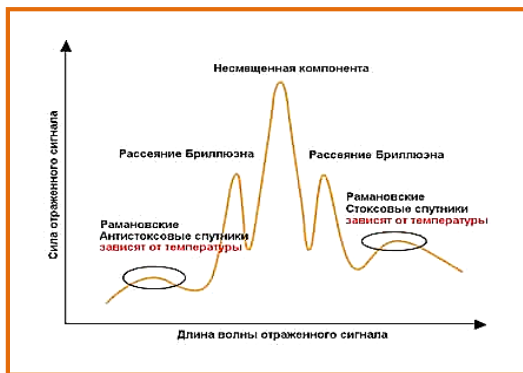
Рис. 55. График Анти-Стоксовской спектральной составляющей (зависимость от температуры)
