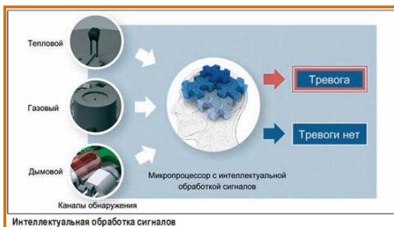
Рис.103. Блок-схема обработки сигналов в ИП комбинированных.
