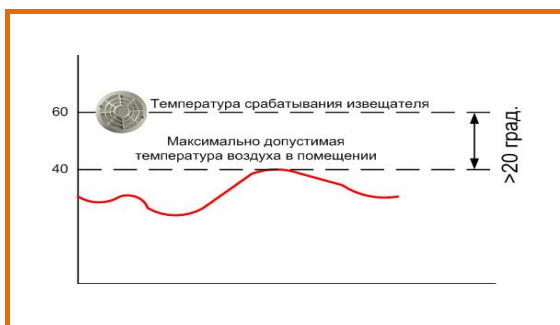
Рис. 23. График зависимости температуры срабатывания ИП теплового максимального
