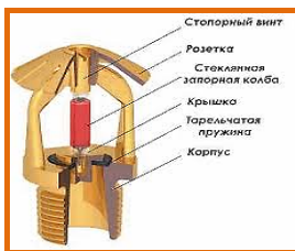
а) спринклерный распылитель с тепловым замком;
