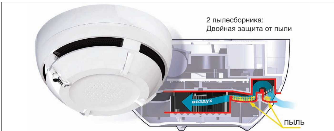
Рис. 2. Два пылесборника – двойная защита от ложных срабатываний
