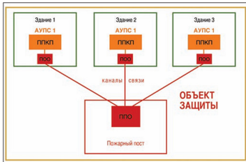
Рис. 1. Объединение АУПС в СПС с помощью СПИ
