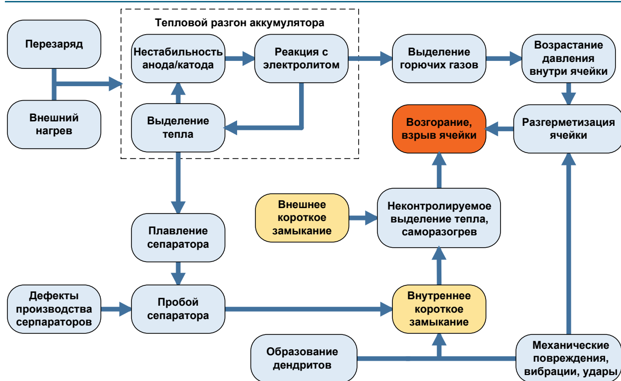
Рис. 3. Схема возможных причин возгорания литий-ионного аккумулятора
